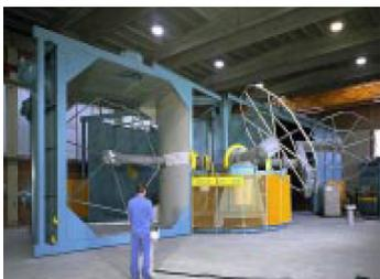
Le fasi che compongono il ciclo di lavorazione del prodotto rotostampato vengono svolte avvalendosi in maniera determinante dell'azione di uno o più operatori: in questo senso il rotomolding è una tecnologia con una forte componente di manualità. Il numero dei pezzi stampabili dipende dalla complessità del prodotto, dalle sue dimensioni e conseguentemente dal tempo necessario al carico/scarico dello stampo.
